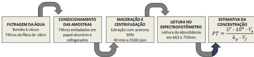
Figura 1 - Procedimento para obtenção da concentração de pigmentos totais, segundo Golterman (1978).
