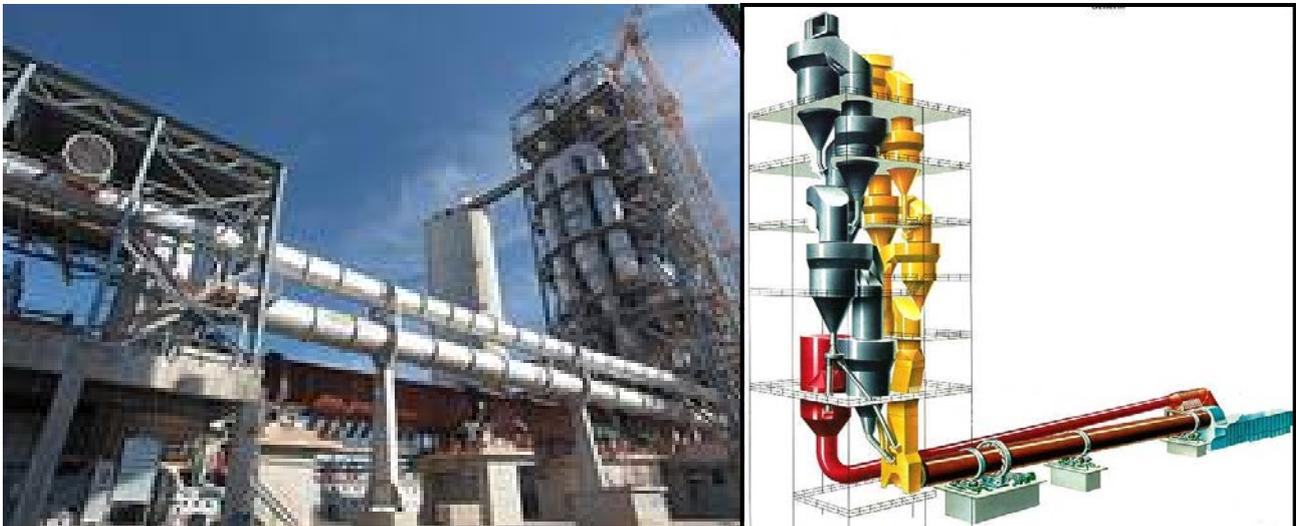
O forno possui uma inclinação da ordem de 3%, a qual, juntamente com a sua rotação, faz com que o cru seja transportado em direção a chama, adquirindo temperaturas crescentes até 1450°C. Esse incremento gradual na temperatura resulta em novas reações químicas, de forma que ao seu final, na saída para o resfriador, todo o cru alimentado na torre esteja transformado em um mineral gerado pela reação no forno denominado "clínquer".
