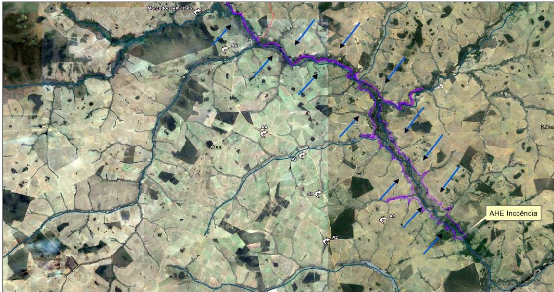
Figura 12. Sentido de deslocamento das águas subterrâneas freáticas. Fonte: Paiva, 2015.
