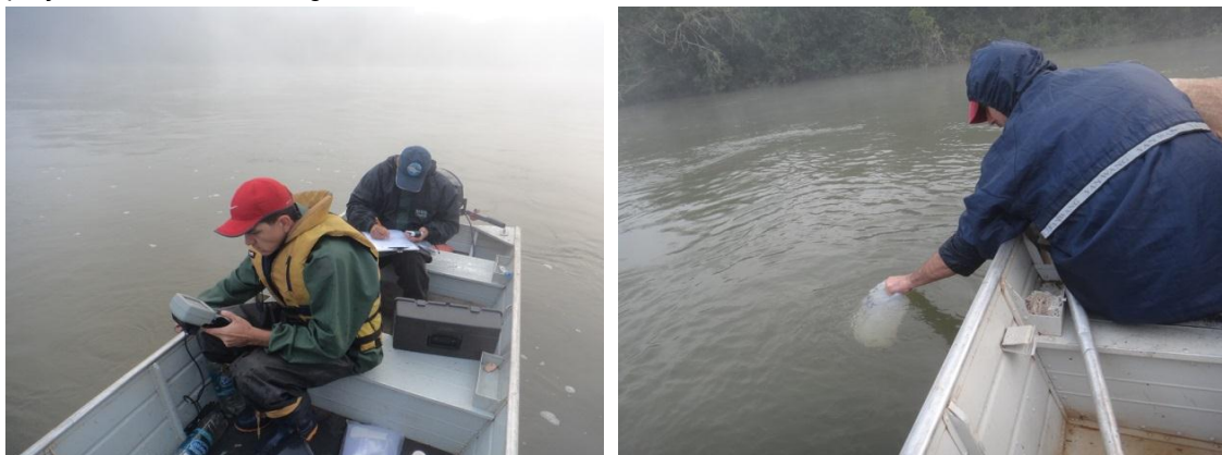
Figura 12. Tomada de parâmetros da qualidade da água in situ e coleta de água. Fonte: INEO, 2015.
