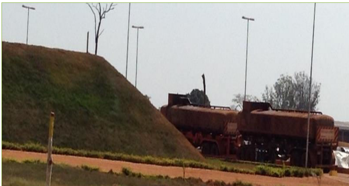
Figura 23 – Carreta tanque para captação e transporte da vinhaça concentrada, representando boa parte desse efluente e sendo uma forma de evitar contaminações e criatório de vetores. Golin, I., 2014
