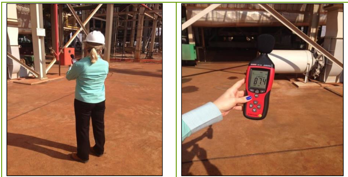
Figura 26 - Realização de Medição de Ruídos na Fonte. Fonte: ARATER, 2014.
