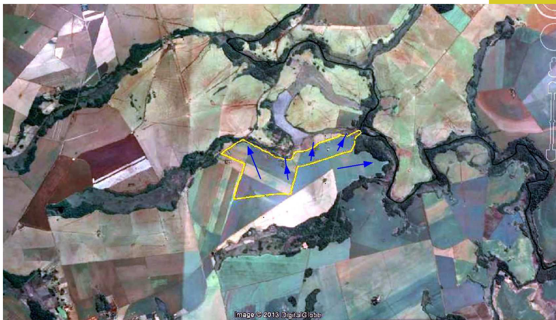
Figura 9: Imagem de satélite demonstrando a migração do lençol freático. Fonte: Digital Globe. Processamento: PAIVA, 2013.
