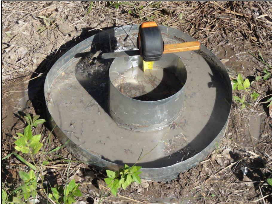
Figura 7.19 - Foto ilustrativa de como se determinou a velocidade básica de infiltração de água no solo.
