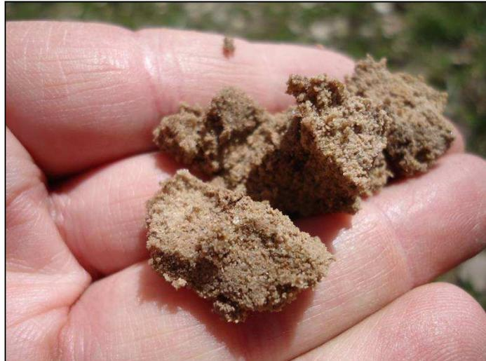
**Figura 7.25 - Amostra de trado demonstrando material mais arenoso onde as águas infiltram com facilidade.**
