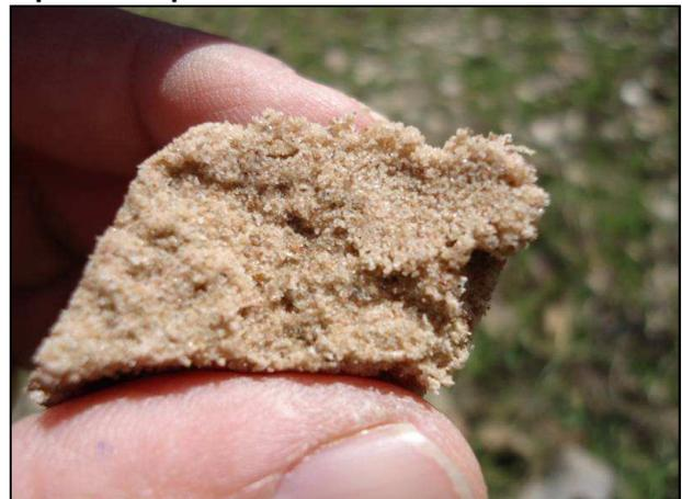
Detalhe do material arenoso coletado com o uso de Trado. Formação Pantanal.
