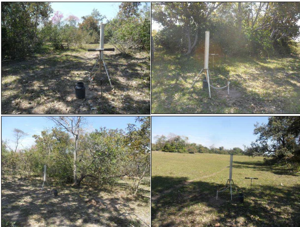
**Figura 7.21 - Fotos com detalhes do permeômetro de Guelph para a determinação da condutividade hidráulica do solo.**
