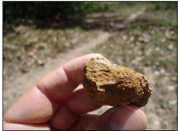
Detalhe das concreções plínticas na Formação Pantanal.
