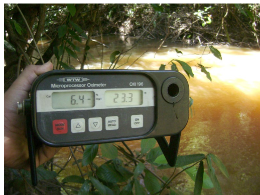
Figura 3. Oxímetro portátil para medição de oxigênio dissolvido e temperatura da água in situ .
