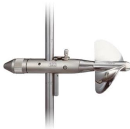
Figura 14 - Exemplo de molinete preso à haste. Fonte: Elaborado pelos autores.
