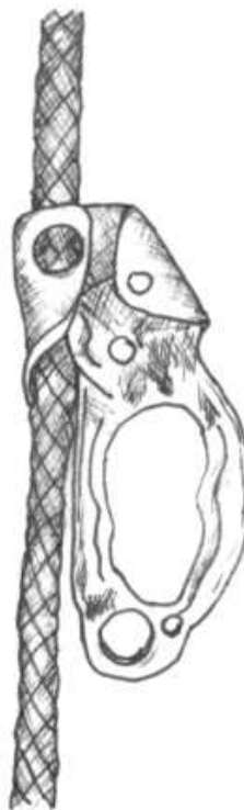
Figura 6 - Ascender, equipamento próprio para escaladas
