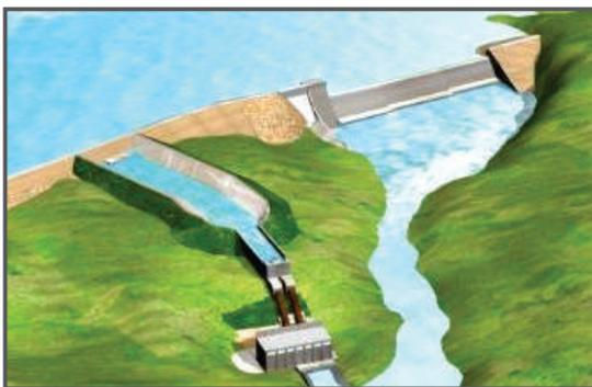
**Figura 1:** Desenho esquemático de uma PCH.
