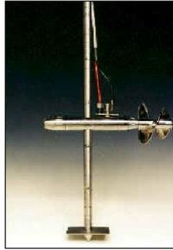
**Figura 4 - Exemplo de Molinete preso à haste**
