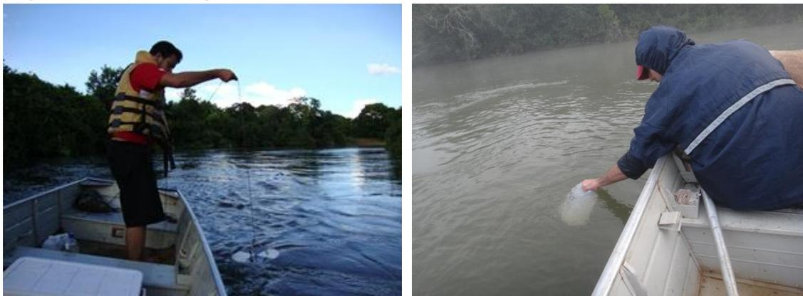
Figura 13. Tomada de parâmetros da qualidade da água *in situ* e coleta de água. Fonte: INEO, 2015.
