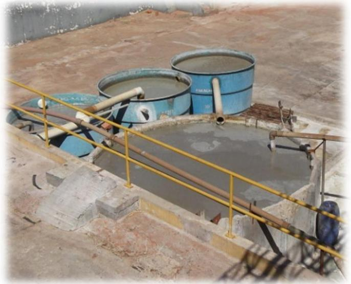
O primeiro sistema de reciclo, o da etapa de caleiro, realiza o peneiramento e a decantação das águas residuárias, retirando-se o material que estava suspenso nelas. Essas águas compõem novos banhos de caleiro (daí o nome do sistema: “reciclo”) e os resíduos retirados, os quais compõem o lodo de caleiro, são encaminhados à fertirrigação de áreas cultivadas.
