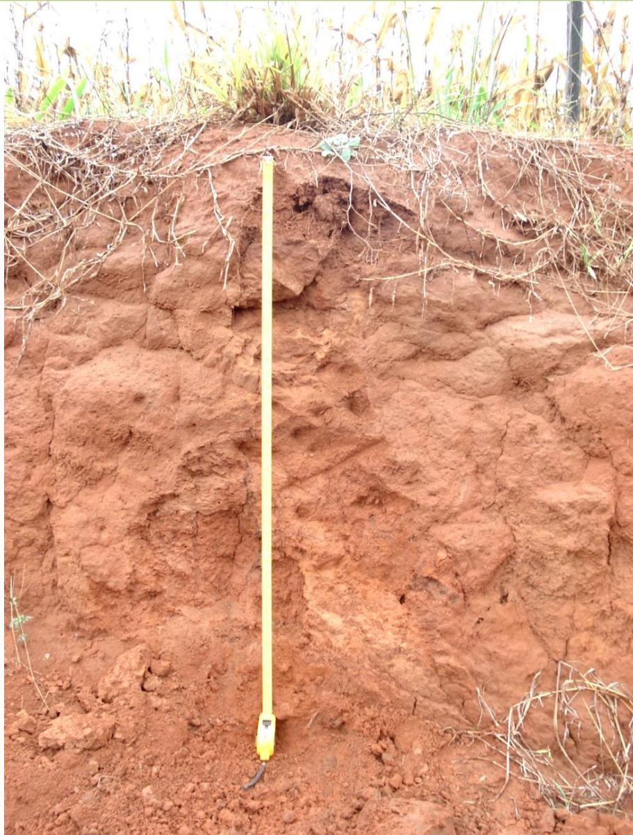
**Figura 15.** Detalhe do perfil argissolo vermelho distrófico e sua profundidade efetiva, nas áreas de influências. Fonte: BONO (2011).
