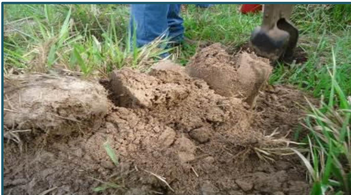
**Figura 14.1 – Amostra sub-superficial obtida por escavação, mostrando a composição arenosa da Formação Pantanal.**
