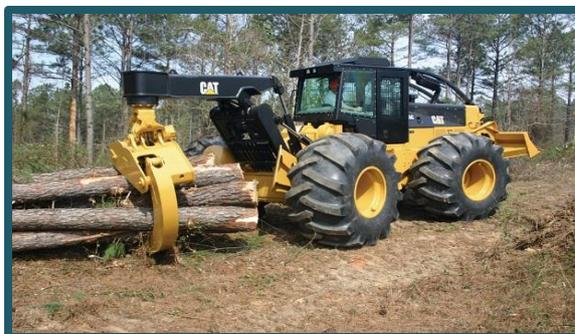
**Figura 5.2 – Trator arrastador (“skidder”).**
