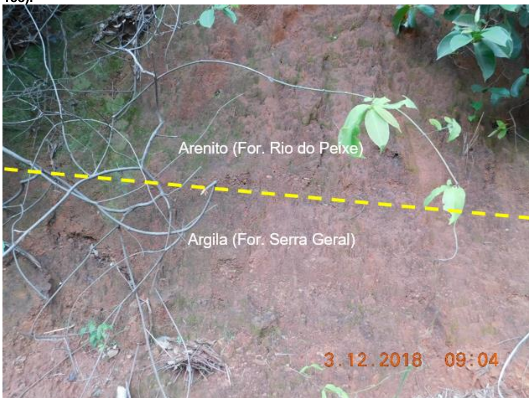
Figura 9.7: Contato entre o arenito da Formação Rio do Peixe exposto em corte da rodovia BR-158, com a argila proveniente da alteração da rocha basáltica da Formação Serra Geral.
