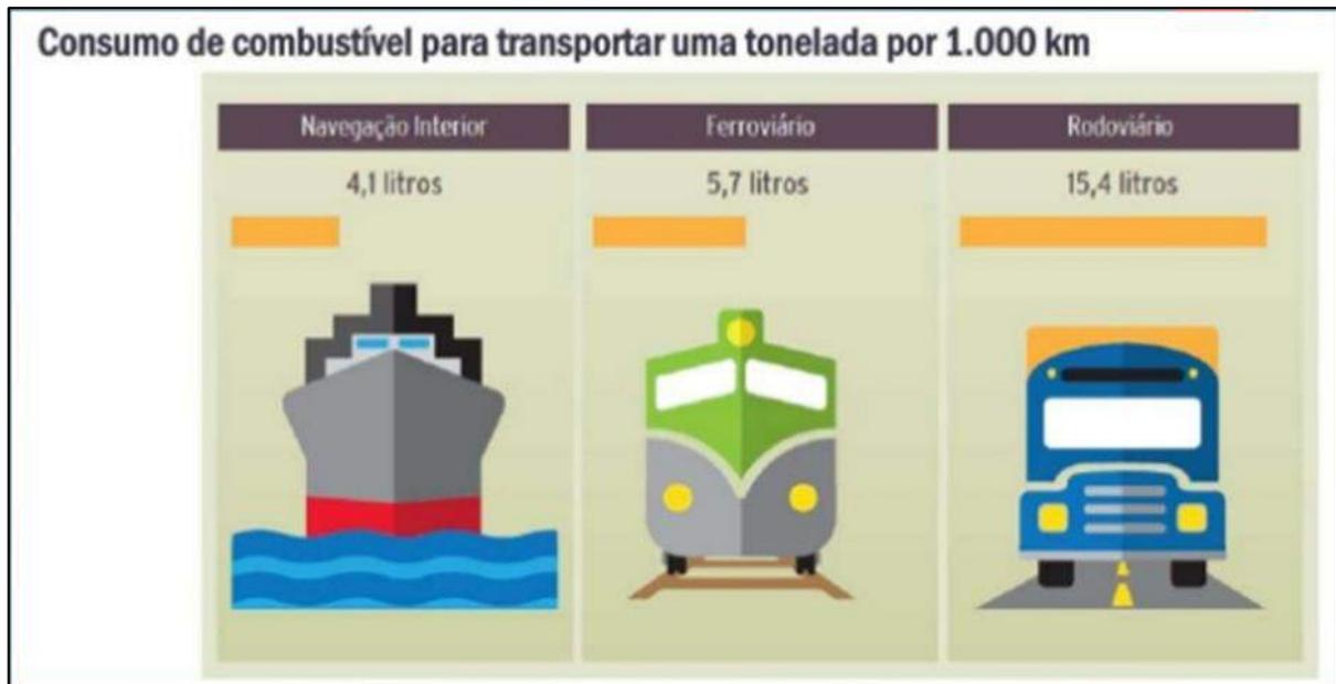
**Figura 4.7 - Consumo de óleo diesel para transportar 1 ton. por 1.000 km.**
