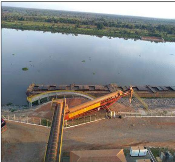
**Foto 3.5 - Vista do transportador telescópico de granéis (telestacker).**
