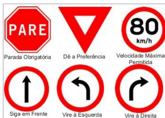
Figura 3 – Placas de sinalização de regulamentação.
