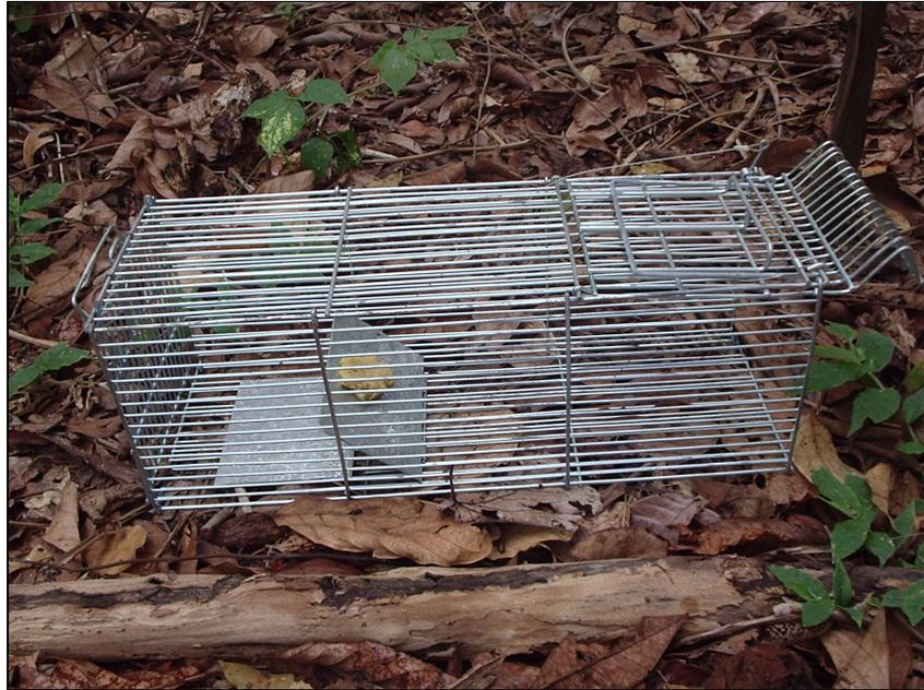
**Figura 5** - Armadilha do tipo *Tomahawk* utilizada para captura de pequenos mamíferos na Avaliação Ecológica Rápida do PE do Pantanal do Rio Negro/MS.
