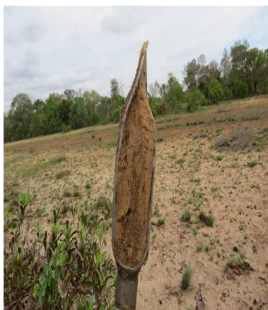
Foto 8.11 – Detalhes do relevo, cor e perfil do Neossolo Quartzarênico Órtico da ADA da Fazenda Santana.
