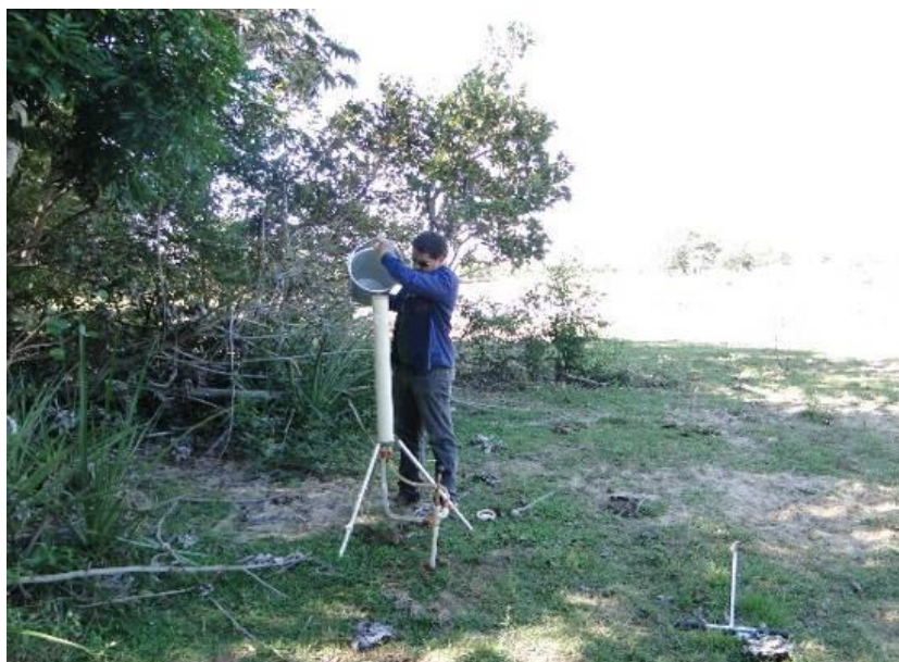
Foto 8.13 – Teste de condutividade hidráulica com o Permeômetro de Guelph na Fazenda Santana.
